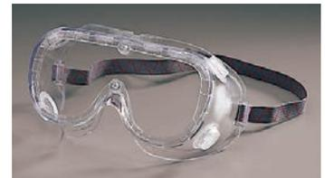
Las gafas no contienen látex ni látex de caucho natural. Tienen aberturas encapuchadas, cuádruples e indirectas para minimizar el empañamiento de las lentes y proporcionar una visión periférica óptima.
